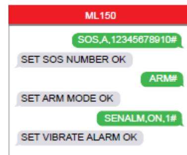
Menține dispozitivul nemișcat peste 5 minute pentru a intra în modul de repaus. Odată vibrat, va trimite mesajul de alertă.
